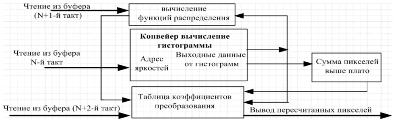
Рис. 3.14. Структурная схема подключения конвейера на ПЛИС
