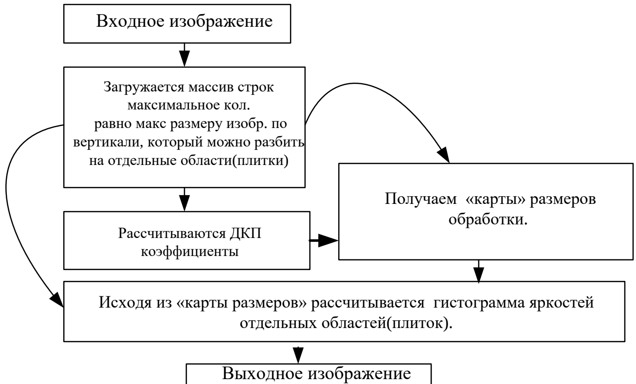
Рис. 3.5. Адаптивный алгоритм на основе частотного параметра изображений.
