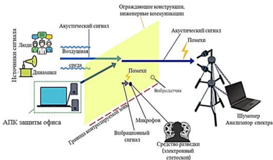
Рисунок 4.24 – Схема проведения эксперимента
