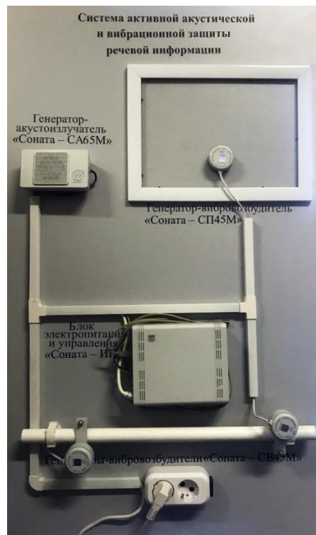
Рисунок 4.7 – Реализованный стенд «Система активной акустической и вибрационной защиты речевой информации»
