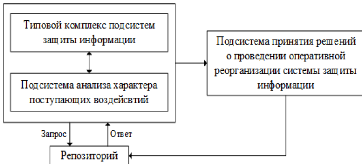
Рисунок 2.2 – Типовая модель адаптации СЗИ
