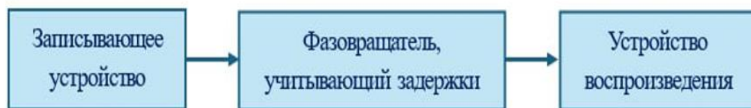
Рисунок 3.3 – Схема генератора формирования компенсирующей помехи
