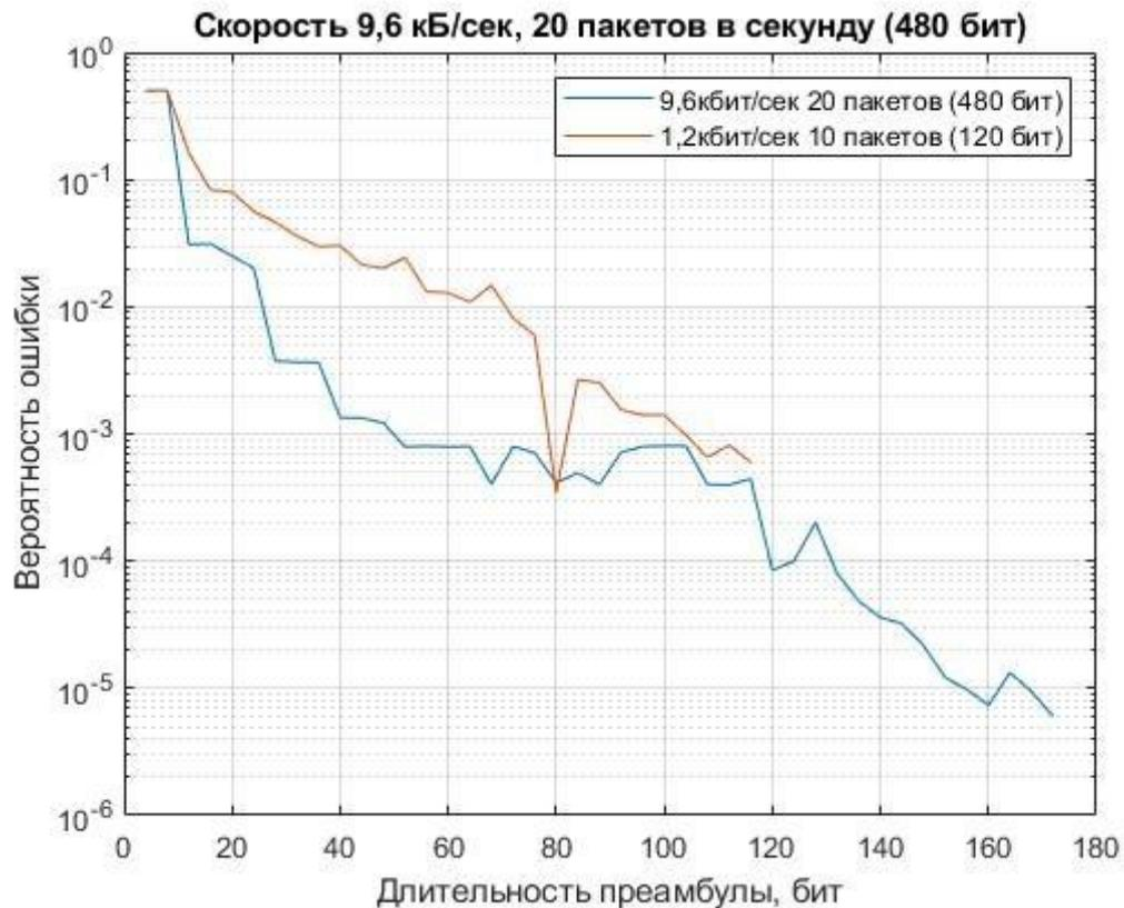
Рисунок 3.31 –Зависимость вероятности битовой ошибки от длины преамбулы [68]
