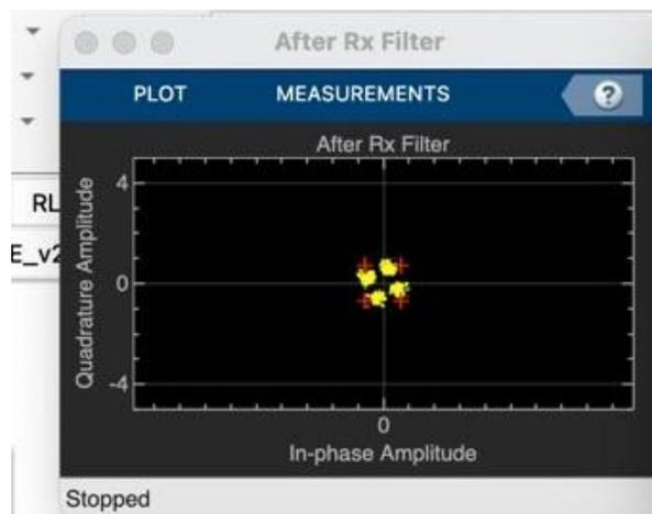
Рисунок 3.22 – After RX Filter – сигнал после фильтра приподнятого косинуса
