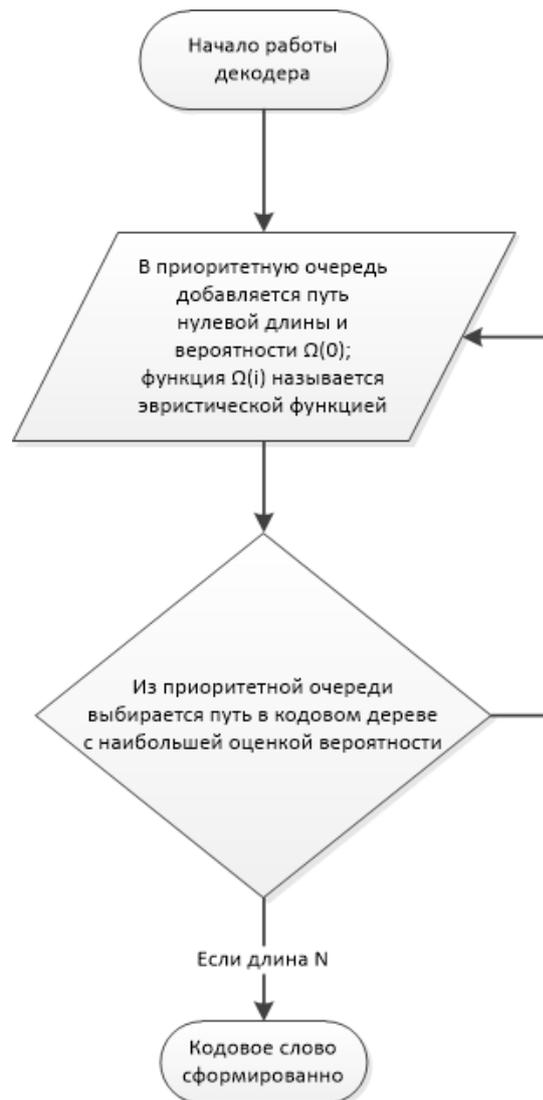
Рисунок 3.3 – Алгоритм декодирования на приемной стороне [120]
