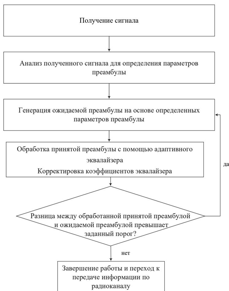
Рисунок 3.17. Блок-схема алгоритма работы эквалайзера на приемной стороне радиолинии
