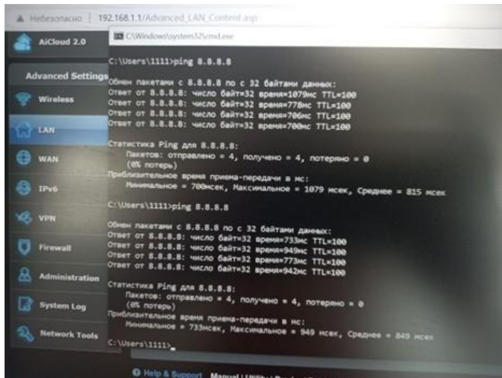
Рис. 32. Окно диагностики роутера с результатами пинга по активной GEO спутниковой ссылке (мин. \approx 700 мс, макс. \approx 1\,079 мс, среднее \approx 0,8 с RTT).
