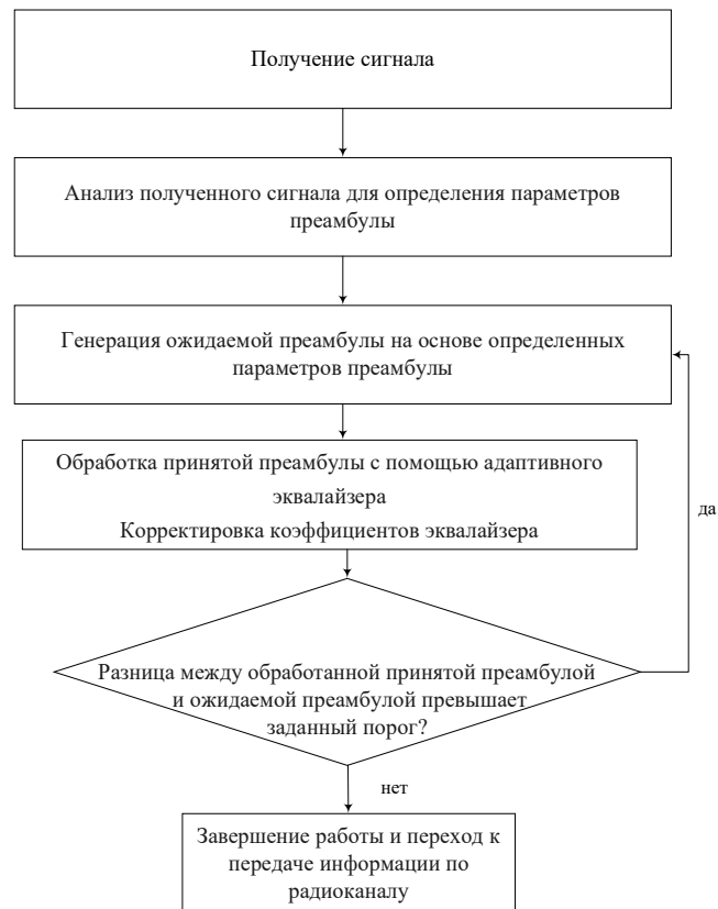
Рисунок 4. Блок-схема алгоритма работы адаптивного эквалайзера
