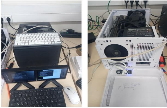
Рис. 20. Два сервера на периферии с GPU NVIDIA RTX 4080 один кодирущик для восходящего канала, другой декодирущик для нисходящего канала работают под CUDA 12 и PyTorch 2.3, подключены в линию между локальной сетью и GEO-модемом.
