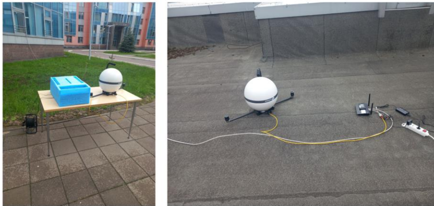
Рис. 22. GEO-модем, используемый в аппаратной тестовой среде.
